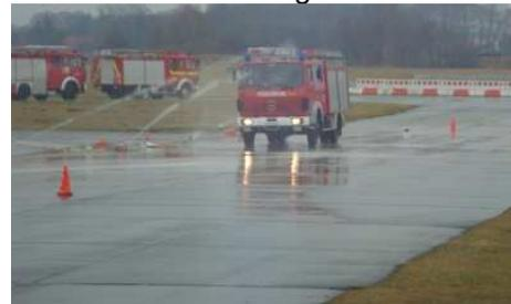
Dies wird vom Kreis Gütersloh für die Feuerwehren angeboten und findet auf dem Militärgelände in Marienfeld statt. Was passiert mit einem Feuerwehrfahrzeug, dass mit Tempo 80 in einer Kurve eine Vollbremsung macht. Wie verhält sich das Fahrzeug auf Grund seines hohen Schwerpunktes und wie verhält sich das Wasser im Tank. Diese und viele weitere Fragen werden bei einem solchen Fahrsicherheitstraining beantwortet und praktisch geübt. Der 23. Mai stand ganz im Zeichen Sportlicher Erfolge.
